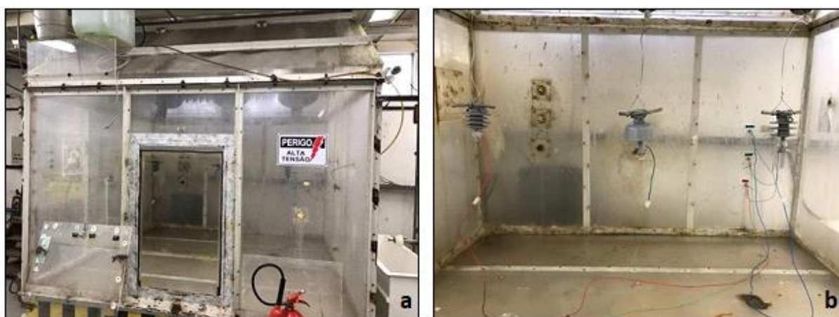
Figura 1. Arranjo experimental do ensaio de névoa salina em isoladores para a medida da corrente de fuga, fase-terra, sendo: em a) foto ilustrativa da cabine de aspersão da névoa salina; e, em b) o arranjo elétrico e de suporte dos isoladores, em linha viva, em seu interior.
