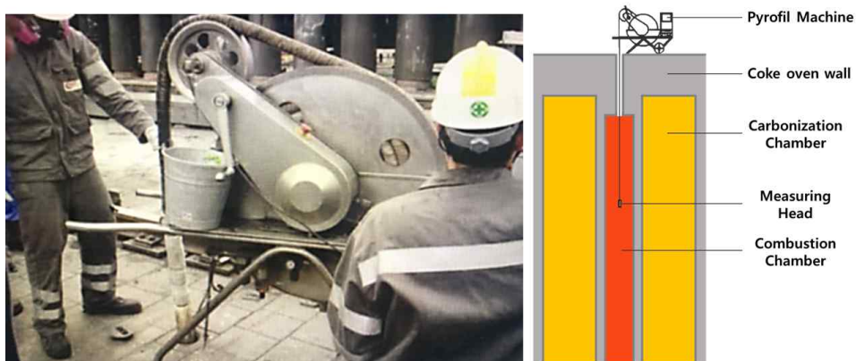
[그림 5-2] Pyrofill machine을 이용한 연소실 내 온도측정
