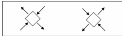
(d) Principal Stresses on the Convex Face
