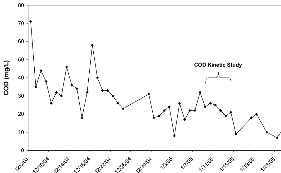
**Figure 4.5 Reactor 2, Effluent COD**
