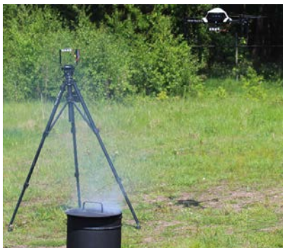
Figuur 7 blauwe lijn sensor op drone oranje lijn sensoren op statief Groen Rook meting alleen met sensor aan het statief, sensor onder de drone vliegt nog op de plek van de nulmeting Grijs Allebei de sensoren doen de eerste meting in de rook. Blauw Drone vliegt naar tien meter zodat er van plek gewisseld kan worden. Paars Allebei de sensoren doen de tweede meting in de rook Oranje Sensoren uit de rook gehaald en opnieuw een nulmeting
