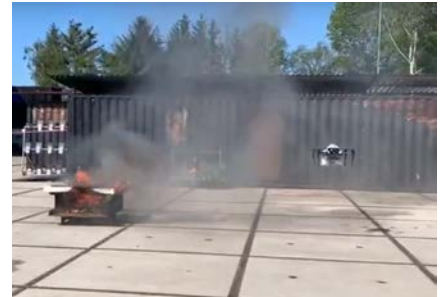
Figuur 17 brand met piepschuim isolatie simulerend een industriële brand
