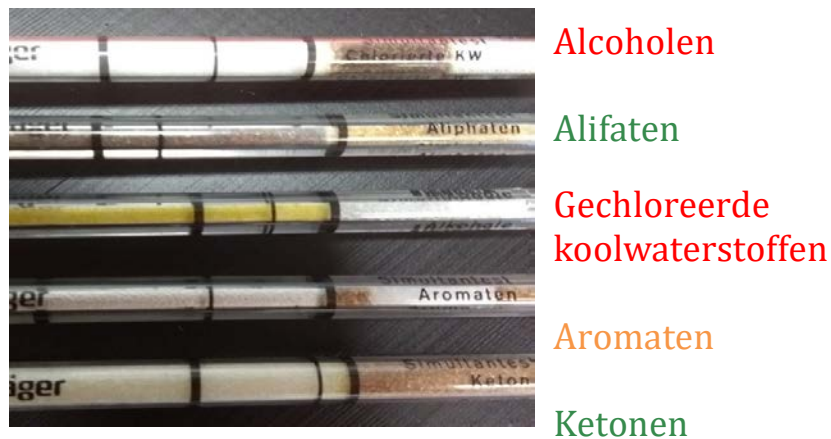
Figuur 10 Gasmeetbuizen van testvlucht met gemeten stofgroepen ketonen en alifaten (groen). Dit komt overeen met verwachtingen vanuit de literatuur 24
