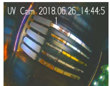
Figuur 9 real-time beeld van gasmeetbuizen tijdens vlucht.
