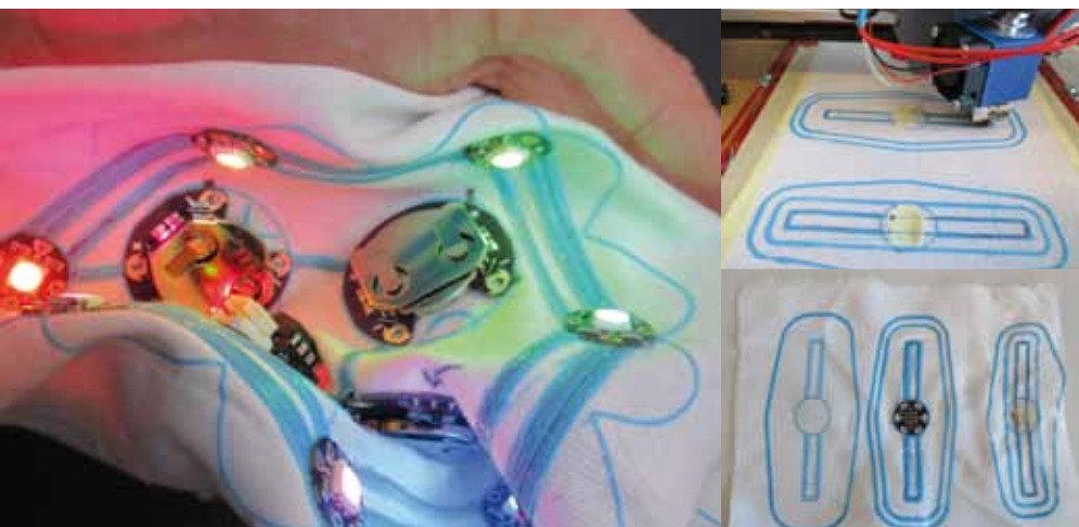
Figuur 2 Foto's van het flexibele Filaflex geprint op 100% katoen. Het Filaflex vormt een gootje waarbinnen geleidend garen verwerkt is. Rechts een LED-systeempje op deze wijze uitgewerkt en geprint.
