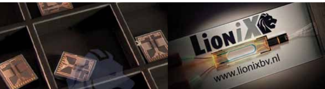
Figuur 2 Een kale optofluidische sensor-chip van 1x1cm uit een siliciumwafel gezaagd in de clean-room (LINKS) en een optofluidisch systeem met fluidische en vezeloptische verbindingen op een houder gemonteerd (RECHTS). De productiekosten van de twee verschillen van elkaar met een factor 10.
