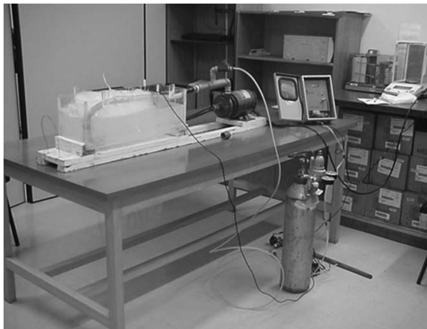
Figura 1 – Protótipo montado para o estudo de neutralização de efluente alcalino usando dióxido de carbono
