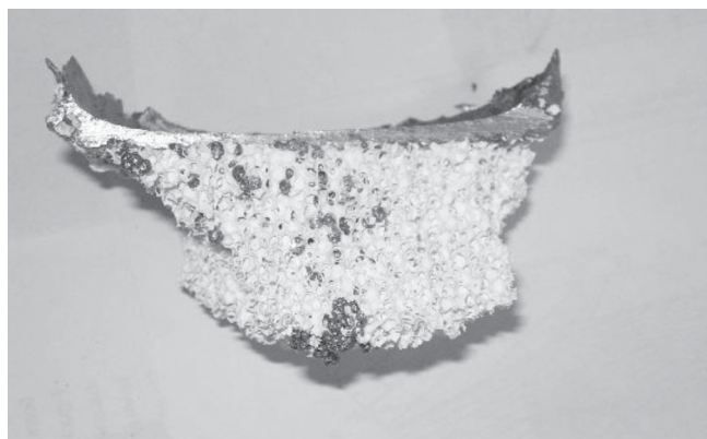
Figura 11 - Seção transversal do filtro evidenciando a obstrução de alguns poros pelo material.
