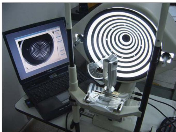
Figura 1 - Discos de Plácido do topógrafo Eyetec CT4000 com conjunto de 8 LEDs brancos, espaçados de 45 em 45 graus. Também podemos ver à esquerda o notebook com imagens de uma esfera de calibração fixada em um suporte com medidor de ângulo. Este suporte foi especialmente confeccionado para este experimento.
