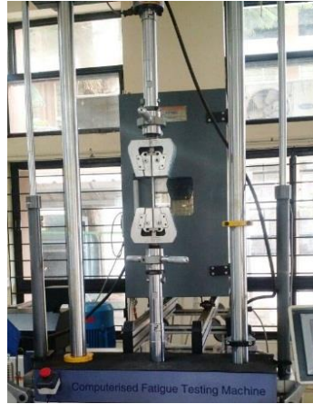
Fig. 3 Tensile test setup
