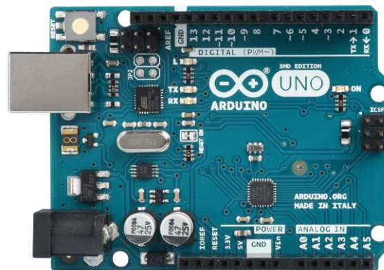
Figure 1. Arduino Uno microcontroller.
