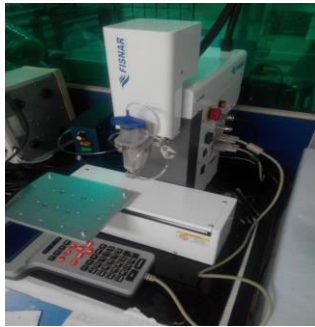
Fig. 2. FISNAR benchtop robot (model F4200N.1)
