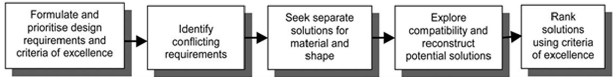
Fig.1 Steps for Hybrid (M.F.Ashby, Y.J.M.Brechet [3])
