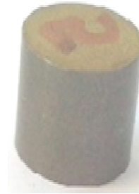
Figure 4 Tool- Tungsten:Copper (70:30)
