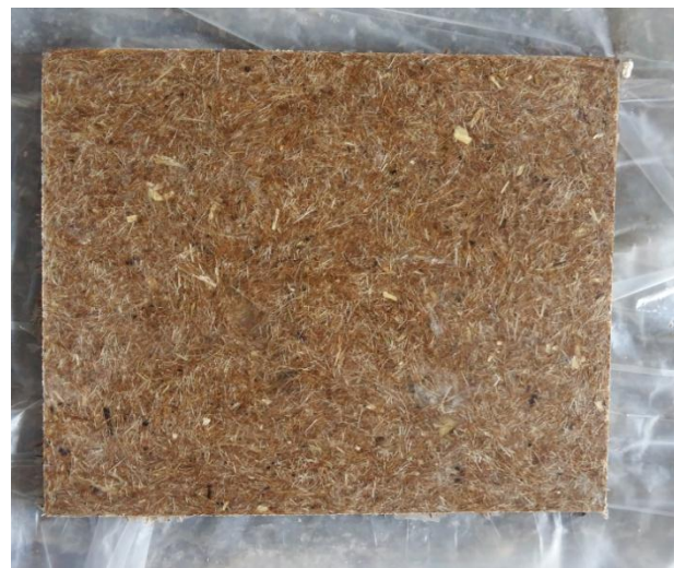
(d) Fabricated composite specimen
