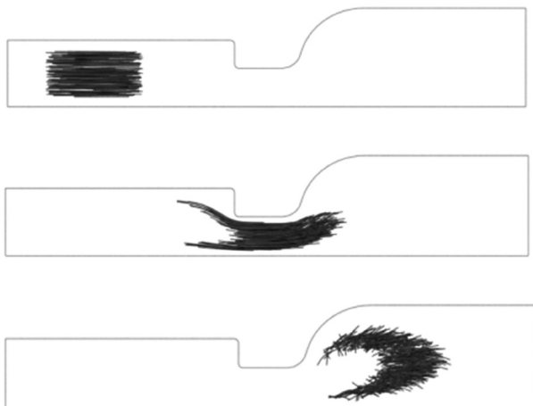
Figura 2. Pieza inyectada con termoplástico reforzado con fibras.
