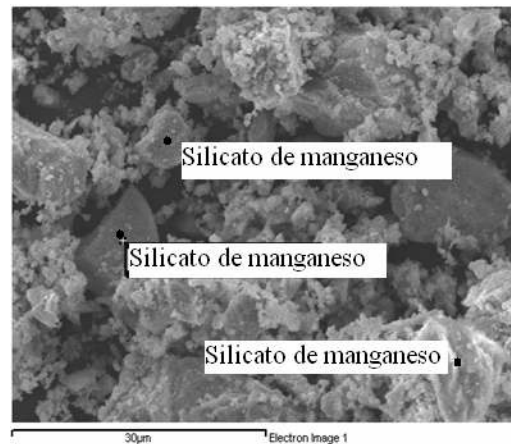
Figura 9. Caracterización del manganeso. SEM/EDS.
