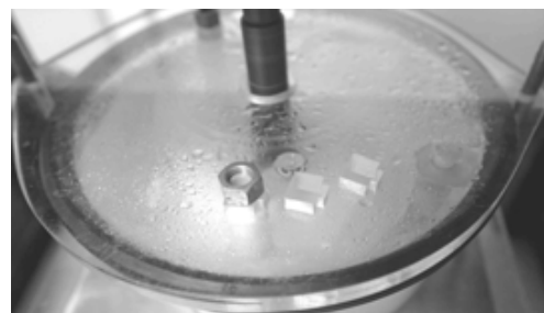
Figura 3. Perforaciones que permiten variar el ángulo medio de impacto de las partículas y el fluido sobre las muestras
