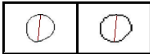
Fig. 5. Medida del diámetro de la imagen a través de sus fronteras superior e inferior
