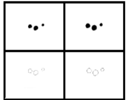
Fig. 3. Umbralizado (superior) y la detección de bordes (inferior) de las imágenes
