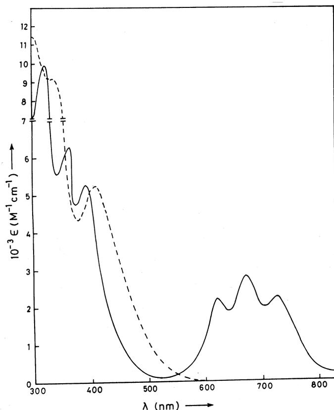
**Figure 1.** UV-Vis spectra of Pd(papm)Cl<sub>2</sub> (----) and Pd(papmO)Cl(—) in CHCl<sub>3</sub> at 298 K.
