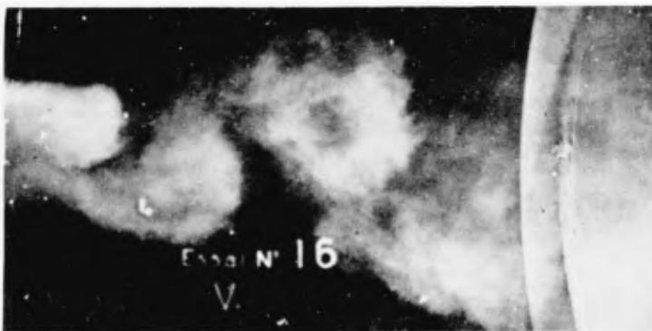
**Fig. 8.-** Sillage de tourbillons alternés derrière une bande poreuse. (Instantané au  $10^{-6}$  seconde)
