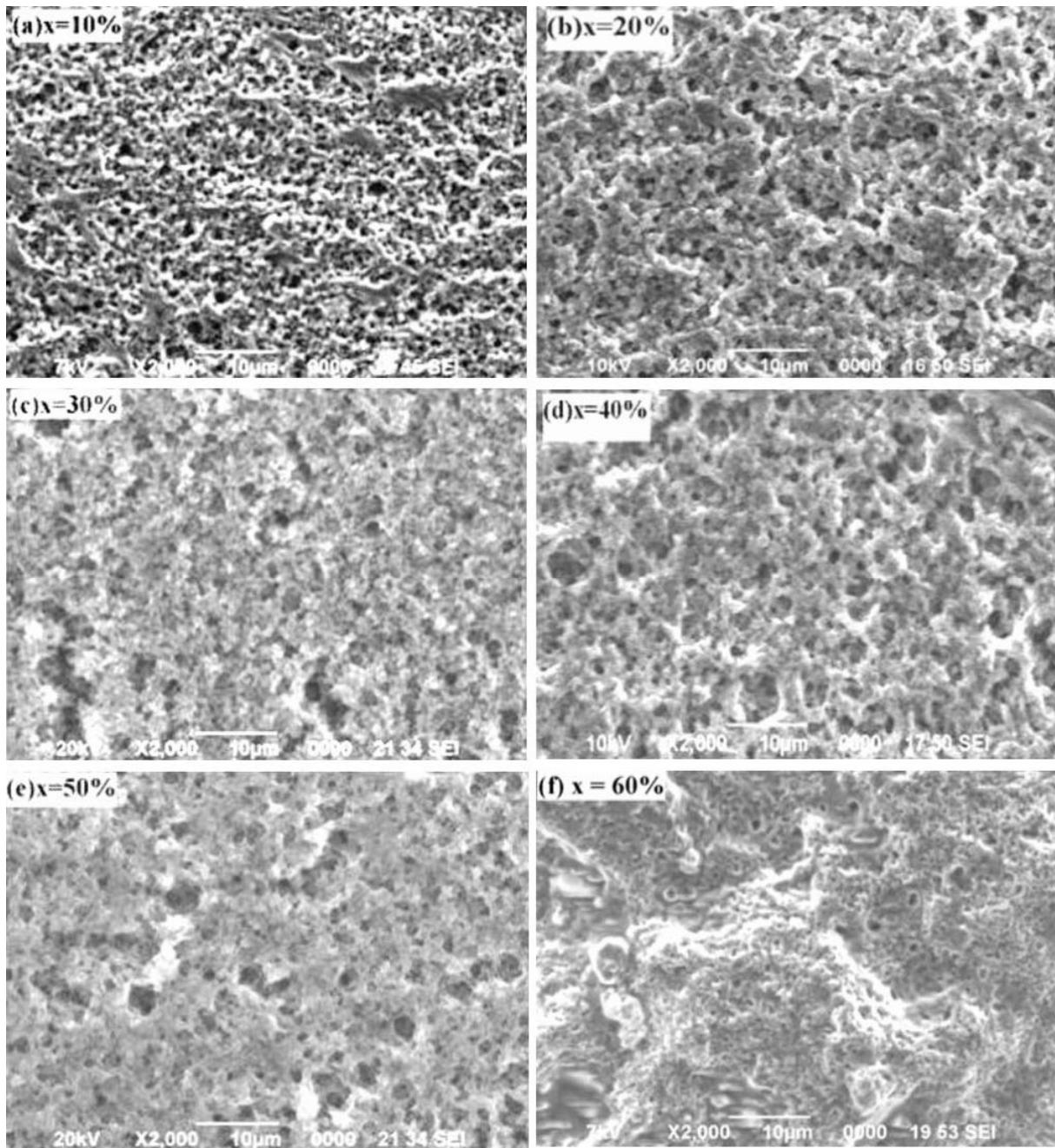
**Figure 1.** Surface SEM micrographs of *P(VdF-HFP)-x%* PEO porous membranes: (a)  $x = 10$ ; (b)  $x = 20$ ; (c)  $x = 30$ ; (d)  $x = 40$ ; (e)  $x = 50$  and (f)  $x = 60$ .
