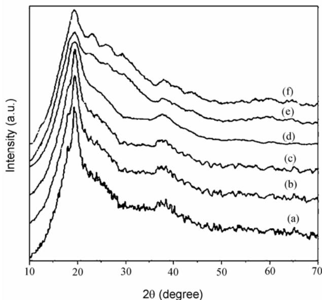
**Figure 8.** XRD spectra of P(VdF-HFP)- $x\%$  PEO microporous membranes: (a)  $x = 10$ ; (b)  $x = 20$ ; (c)  $x = 30$ ; (d)  $x = 40$ ; (e)  $x = 50$  and (f)  $x = 60$ .
