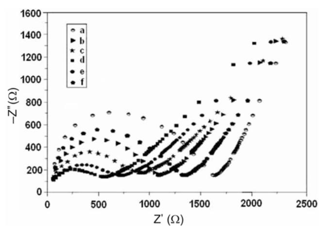
**Figure 4.** Room temperature impedance plots of P(VdF-HFP)-x% PEO microporous membranes: (a)  $x = 10$ ; (b)  $x = 20$ ; (c)  $x = 30$ ; (d)  $x = 40$ ; (e)  $x = 50$  and (f)  $x = 60$ .
