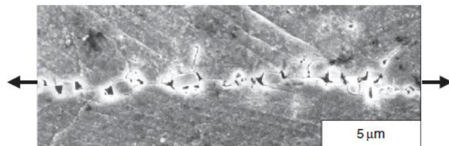
Fig. A.3. Necklace void coalescence mode (1)
