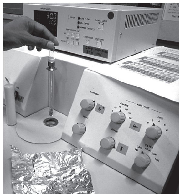
第 1 図 NMR 測定の実際。NMR 管に詰められた初のプロープへのセット (田中浩平)
