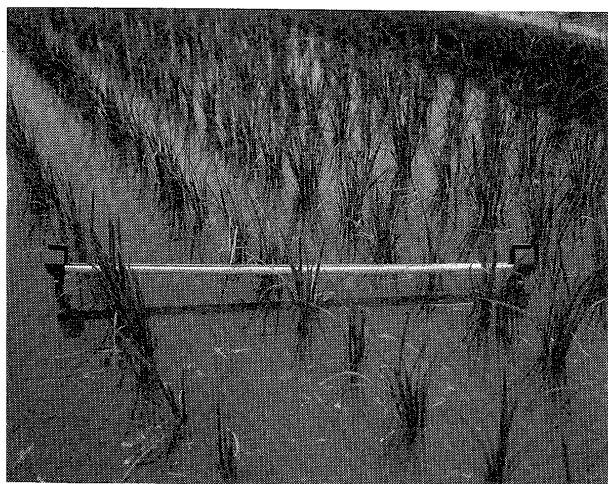
第2図 簡易積算管型日射計を用いたイネ個体群の透過量の測定.
