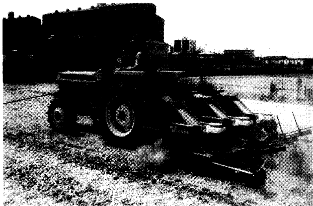
第1図 3条用ダイズ不耕起播種機の概要。
