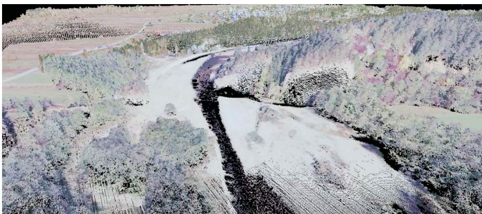
Fig. 7. The result of integrating data from the airborne and terrestrial laser scanning Rys. 7. Wynik integracji danych z lotniczego i naziemnego skaningu laserowego
