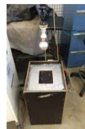
Fig. 2 Thermal gradient 'Heat Box' set up
