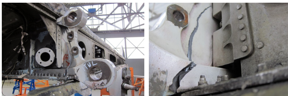
Rys. 2. Krytyczne uszkodzenie uzyskane na koniec pełnoskalowej próby
