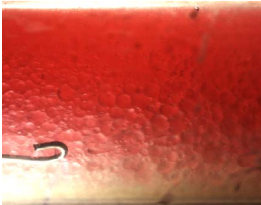
Figure 32 - v_{s0} = 1.000 m/s v_{sw} = 0.400 m/s (DO/W&DW/O)
