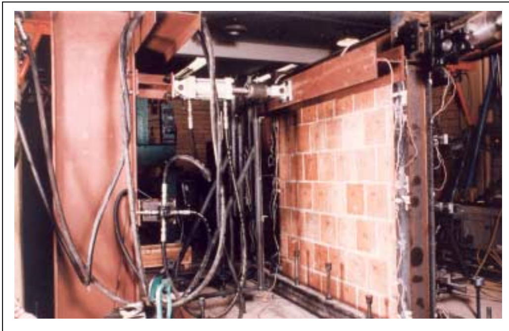
FIG. 9. Moderate-scale Out-of-plane Drift Test
