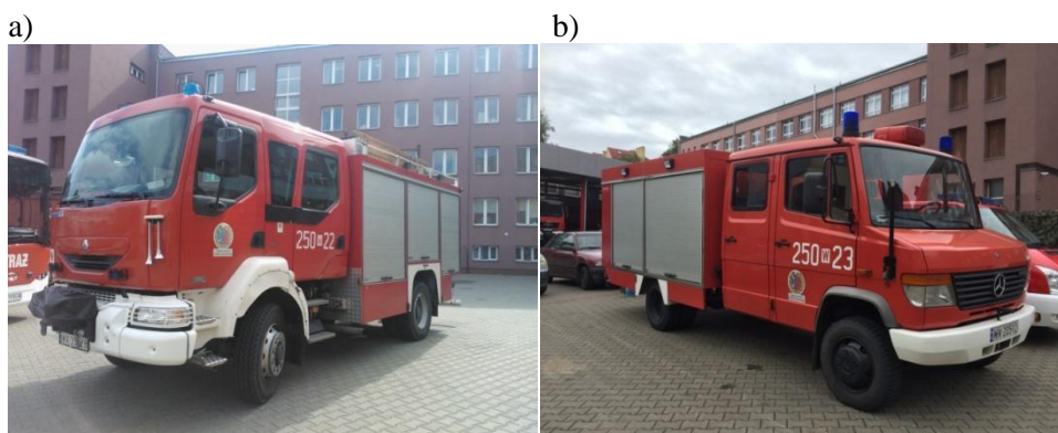
Rys. 1. Średni samochód ratowniczo-gaśniczy na podwoziu producenta marki: a) Renault Midlum, b) Mercedes-Benz
