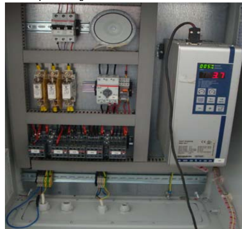
Fig. 5. Industrial softstarter MSF-017 test stand set up
