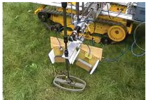
Fig. 21. The MD and GPR antennas.
