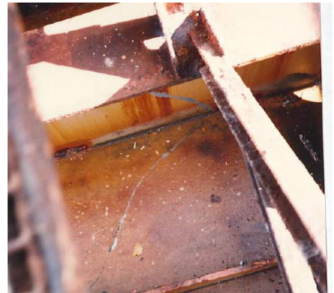
Figure 52. Fractures caused by LNG spills on actual LNG vessels (Roue, 2011)
